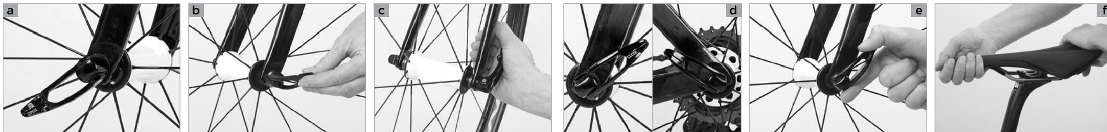
Pour contrôler le blocage de la selle par l'attache rapide, essayez de déplacer la selle angulairement par rapport à l'axe du tube de selle **(f)**.
