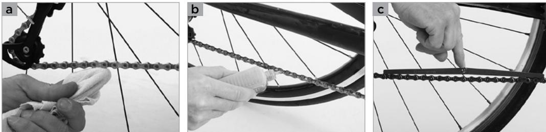
Leur remplacement entraînera plus de coûts que le remplacement de la chaîne, si celui-ci est réalisé à temps. Nous vous recommandons par conséquent de vérifier régulièrement l'état d'usure de votre chaîne.
