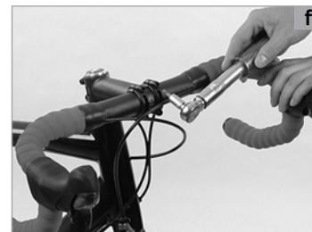
Sur **SRAM** vous changez d'abord les comes sur les commandes de vitesses légèrement retirées et pivotée. Ensuite vous serrez la vis cache en dessous du caoutchouc à l'aide d'une clé Allen.
